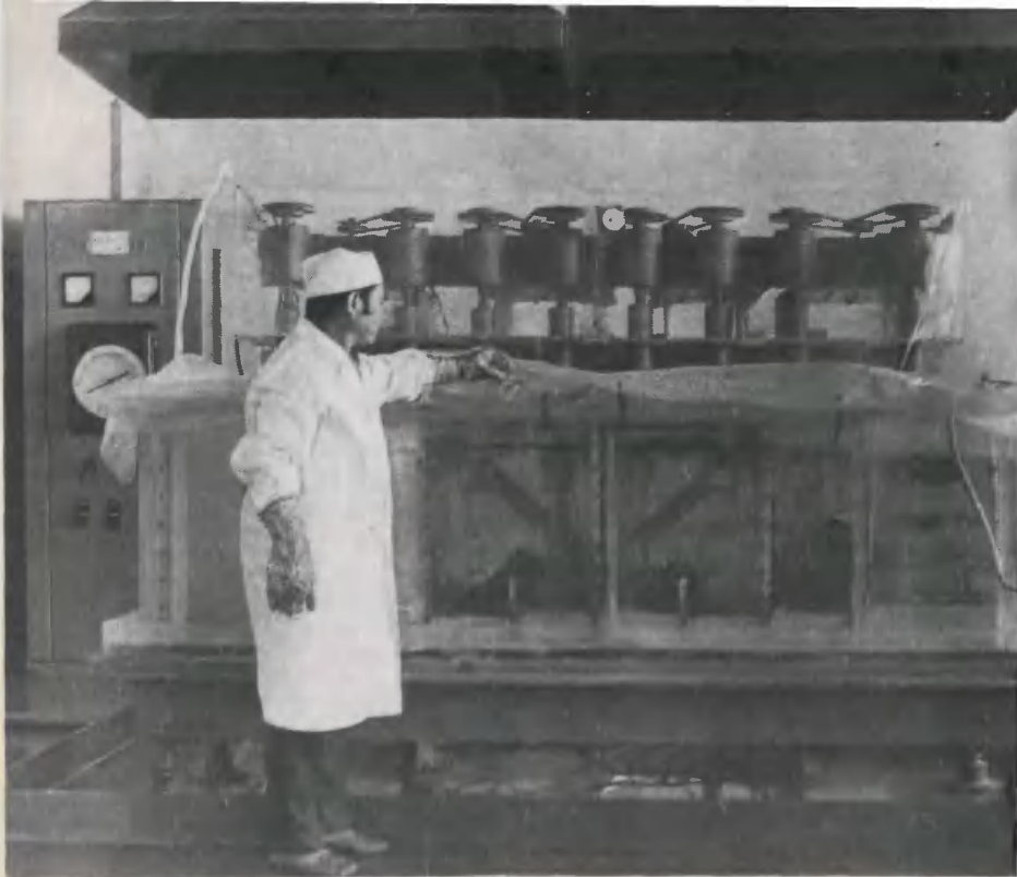
Так выглядит промышленный электролизер.
